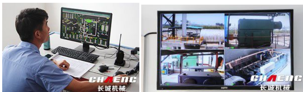
图：长城机械矿渣立磨机智能操作系统，实时对生产运营中存在的隐患进行监控和调整
